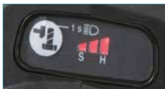
Drie-traps elektronische snelheidskeuze.
